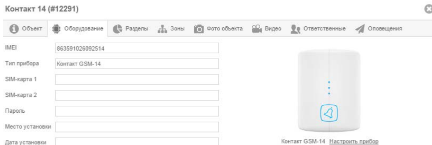
Рисунок 8. Настройка прибора через GEO.RITM
