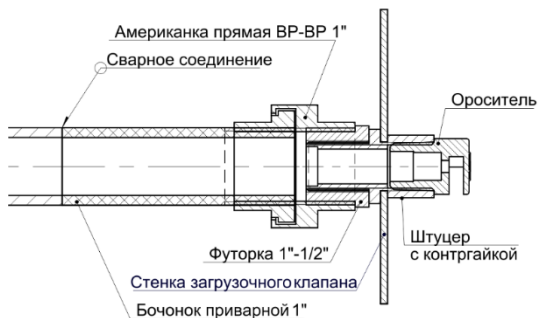
Рисунок 3 – Монтаж оросителя.
