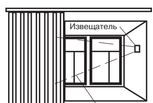
Рисунок 7 – Установка извещателя между стеклом и занавесями (жалюзи)
