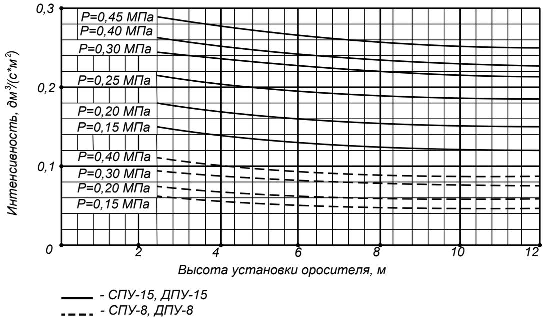
Графики зависимости средней интенсивности орошения от давления на защищаемой площади 12 м<sup>2</sup> при высоте установки оросителей 2,5 м
